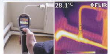
パイプ内の堆積物を診断! ※ベドロが付着したパイプ内部の状態がパイプの外側の表面温度に影響する場合があります。
