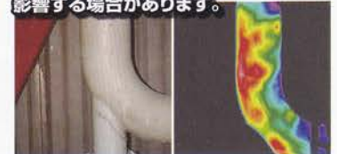
パイプ内の堆積物を診断! ※ベドロが付着したパイプ内部の状態がパイプの外側の表面温度に影響する場合があります。
